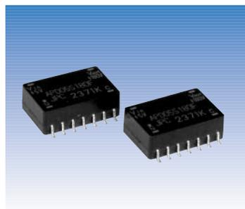
APDシリーズの小型、SMD化。高速光通信受光素子、アバランシェフォトダイオードのバイアス電源として開発されました。入力5Vの低電圧よりバイアス用の高電圧が得られます。入出力絶縁型。
